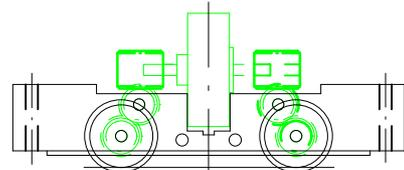
Noch in diesem Jahr wird unsere neue Antriebsgeneration mit Faulhabermotor verfügbar sein. Die Rahmen der Antriebe werden aus Messing CNC-gefräst. Alle Abtriebskomponenten werden aus Messing bzw. Stahl gefertigt.
