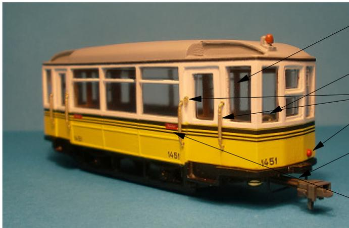
Trennwände aus geätztem Messingblech
