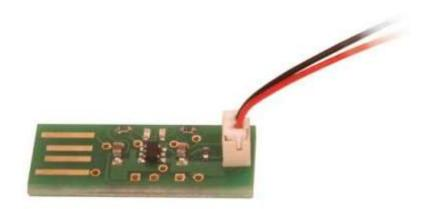
Die Lipo-USB-Ladeplatine ist ein USB-Ladegräte für einzellige LIPO-Akkumulatoren. Es wird einfach in den Laptop, USB-Netzteil oder in eine Powerbank gesteckt und lädt einzellige Lipo-Akkumulatoren. Der Akkumulator kann damit nicht überladen werden.
